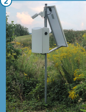
Videoüberwachung und Alarmbox zur direkten Warnung von Anwohnern
