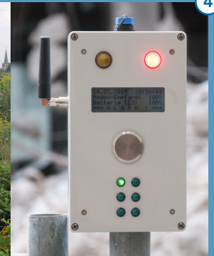
Videoüberwachung und Alarmbox zur direkten Warnung von Anwohnern
